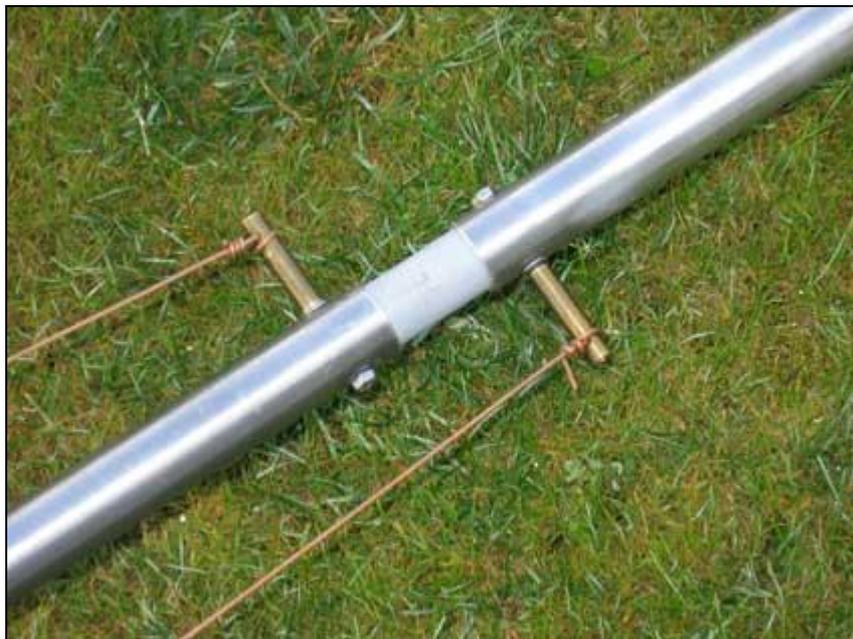
**Перед сборкой элементов необходимо на каждую центральную часть элемента одеть два изолятора, выполненные из пластика (полиамид ПА-6 или полиэтилен).**
