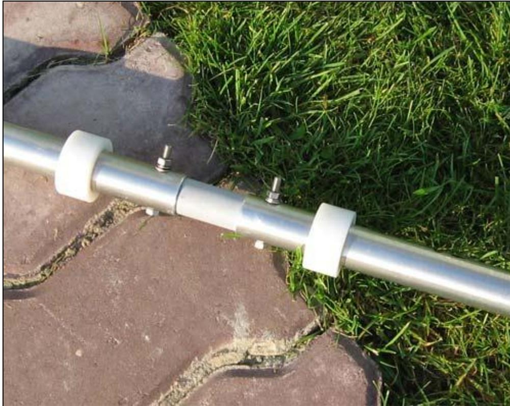
Хорошая идея - перед сборкой разметить места для изоляторов на центральной секции. Крепление «элемент – бум» имеет ширину около 140мм.
